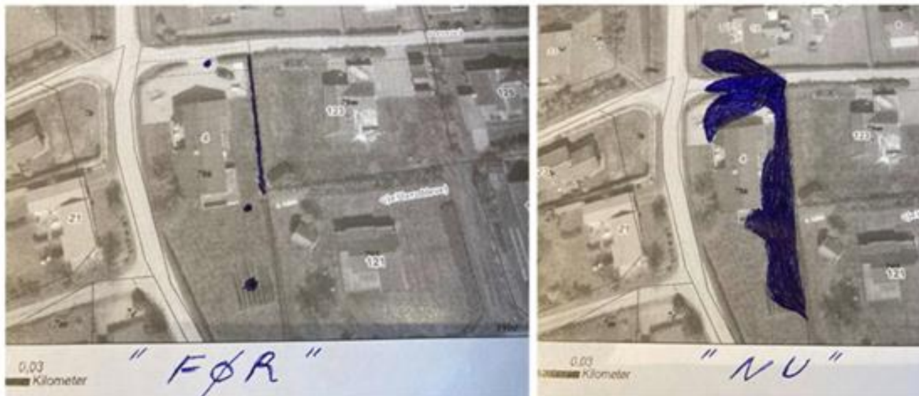
Det indtegnede viser hvor der før og efter terrænregulering står vand på Porsevej 4, flere fotos fremgår af bilag 2.
